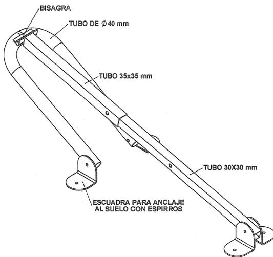
Fabricado en tubo de acero al carbono, no rompe a los golpes, pintado con pinturas especiales para exterior, taladros para poner candado.
