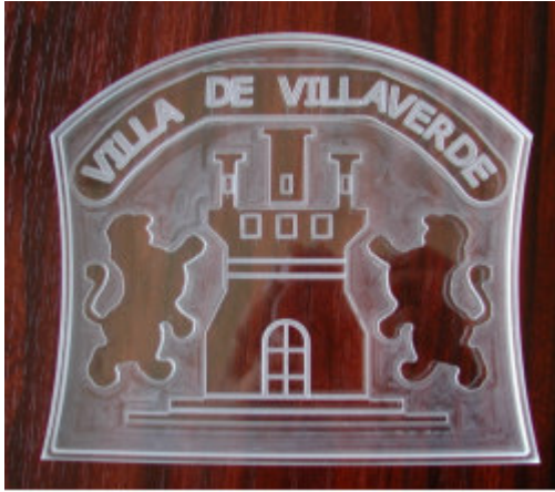
Mecanizado sobre relieve en metacrilato de 10 mm
